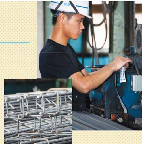
「鉄は、溶接すると弱くなる性質がありますが、弊社は溶接しても強度が変わらない「加圧溶接」という新工法で溶接しています」(山本氏)
